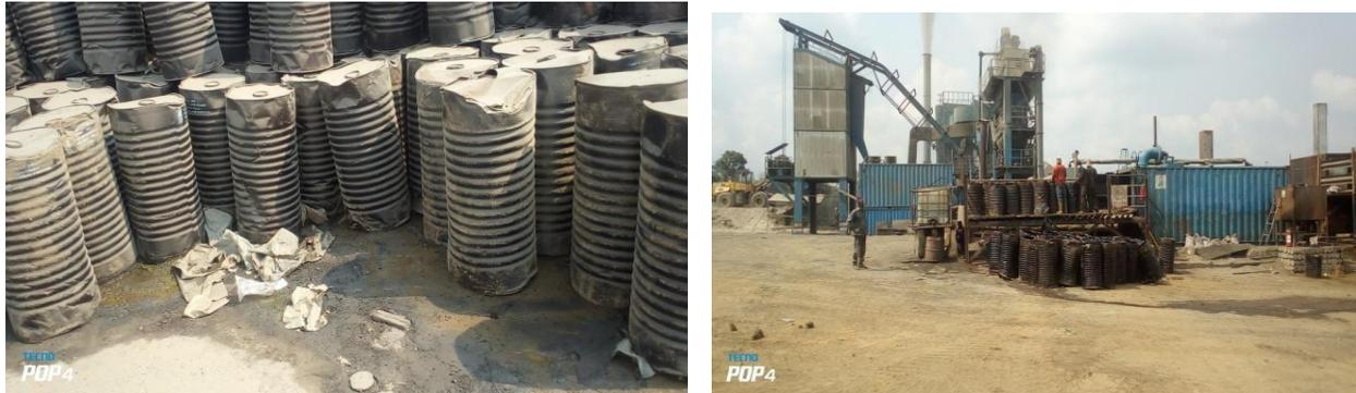
*Figure 6: Déversement des produits bitumineux au sol.*
